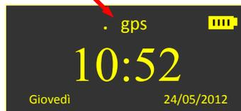
2. **ripetere la stessa operazione come al punto 1.** tenere premuto il tasto **sos** per alcuni secondi - fino a quando il **segnale acustico** avviserà che il comando di è stato eseguito - se il sistema **GPS** è stato correttamente **ATTIVATO**, il puntino sul display apparirà lampeggiante - sistema **GPS** correttamente **attivato** - attendere finché non appare la scritta "**GPS**" **maiuscolo** con lo sfondo in reverse - del tipo:
