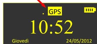
Il sistema **GPS** del terminale **L'OTTO** può essere "**ATTIVATO**" o "**DISATTIVATO**" manualmente - normalmente il sistema **GPS** è **ATTIVO** - il puntino alla destra della scritta è lampeggiante - anche se disattivato manualmente il sistema **GPS** del terminale **L'OTTO** si riattiva automaticamente alla prossima accensione (sia l'accensione manuale, sia con l'accensione automatica)
